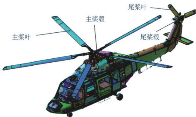
图1 旋翼系统结构示意图
